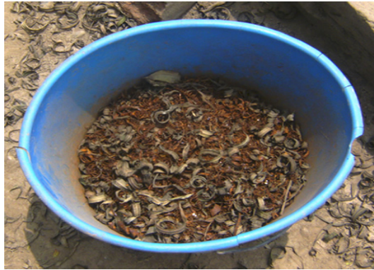
Figura 17: Viruta de hierro, utilizada para eliminar el sulfuro de hidrógeno.
