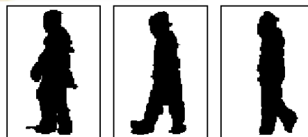
Figura 3: Resultado optimo de una detección de foreground, con eliminación de ruido(imagen tomada de [4])
